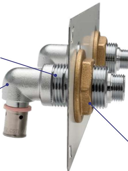
Sortie M3/8 (sur cette photo) permet de **raccorder directement les flexibles** de la robinetterie ou F1/2 pour intercaler un robinet d'arrêt
