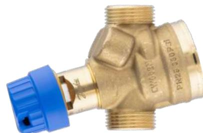
**La vanne AB-QM** est une vanne de régulation indépendante de la pression. Elle dispose d'une fonction d'**équilibrage automatique et limitation de débit**.
